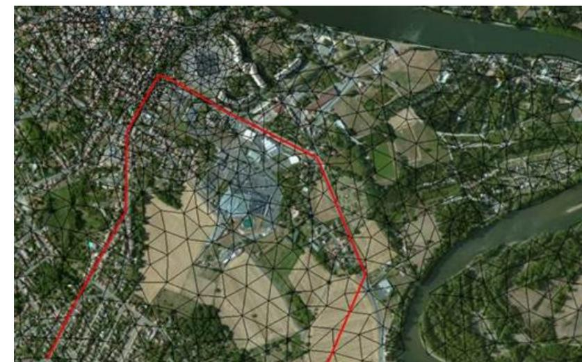
Figure 3 : Digue testée dans le modèle hydraulique affiné
